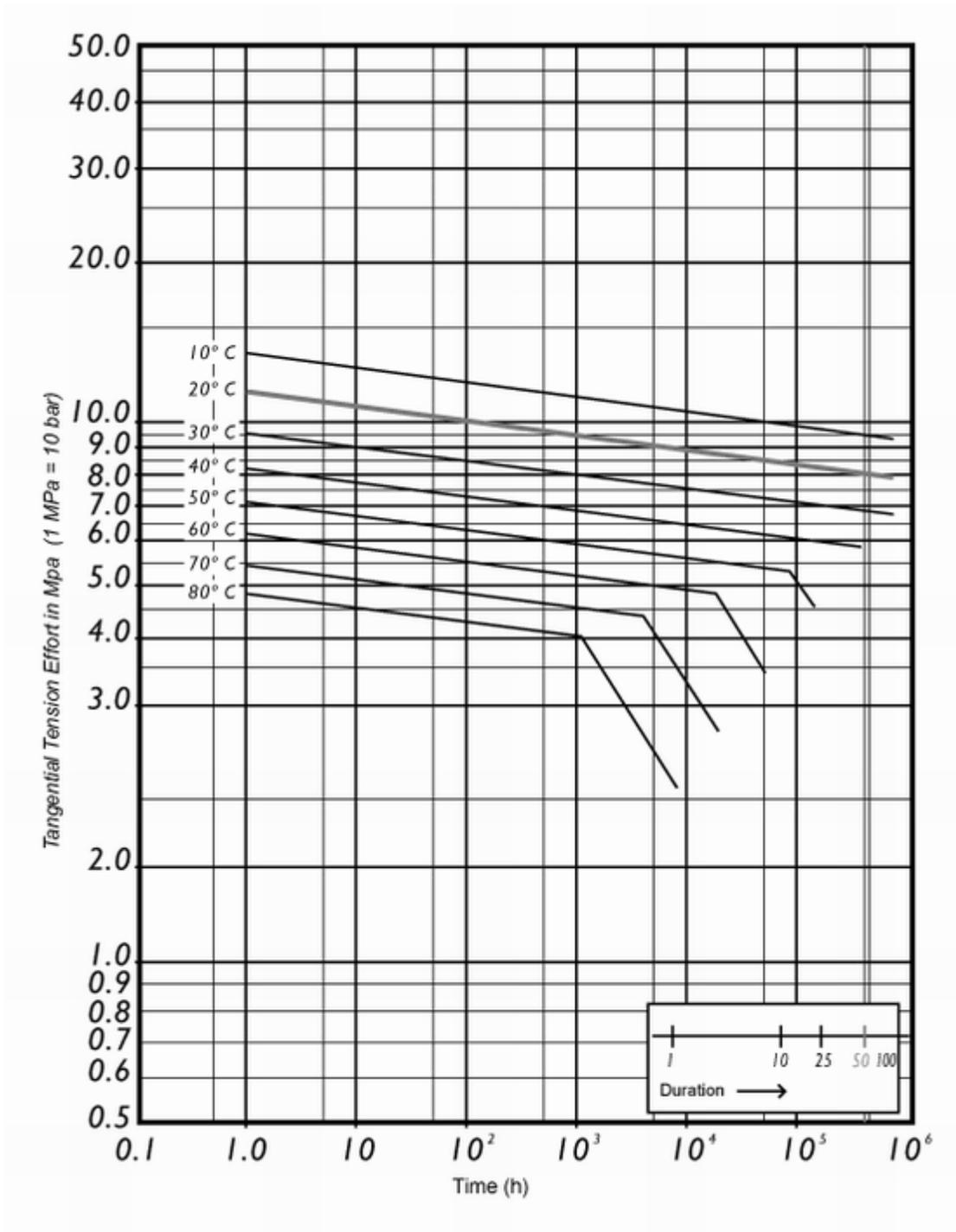
Fig. 3 - Regression curves PE80 (Source DIN 8074)
